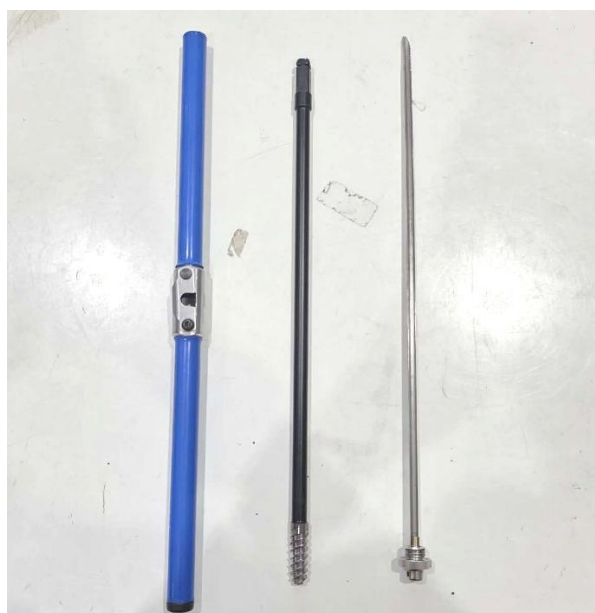
รูปที่ 2 ส่วนประกอบ: ด้ามจับ (ซ้าย) ดอกเจาะ (กลาง) และที่ดึงแกนไม้ (ขวา)
