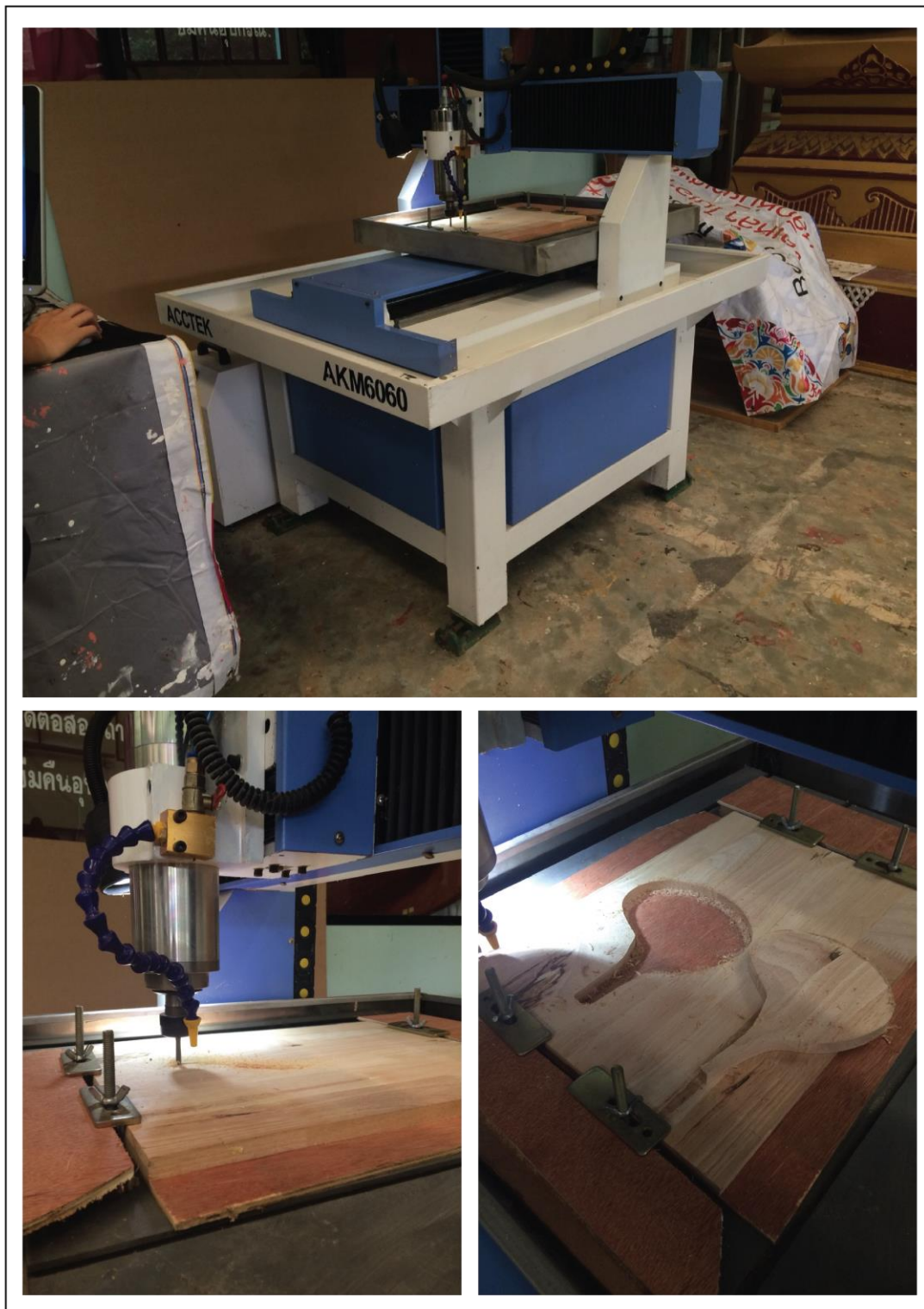
ภาพที่ 96 ขั้นตอนการตัดไม้โดยใช้เครื่อง CNC
