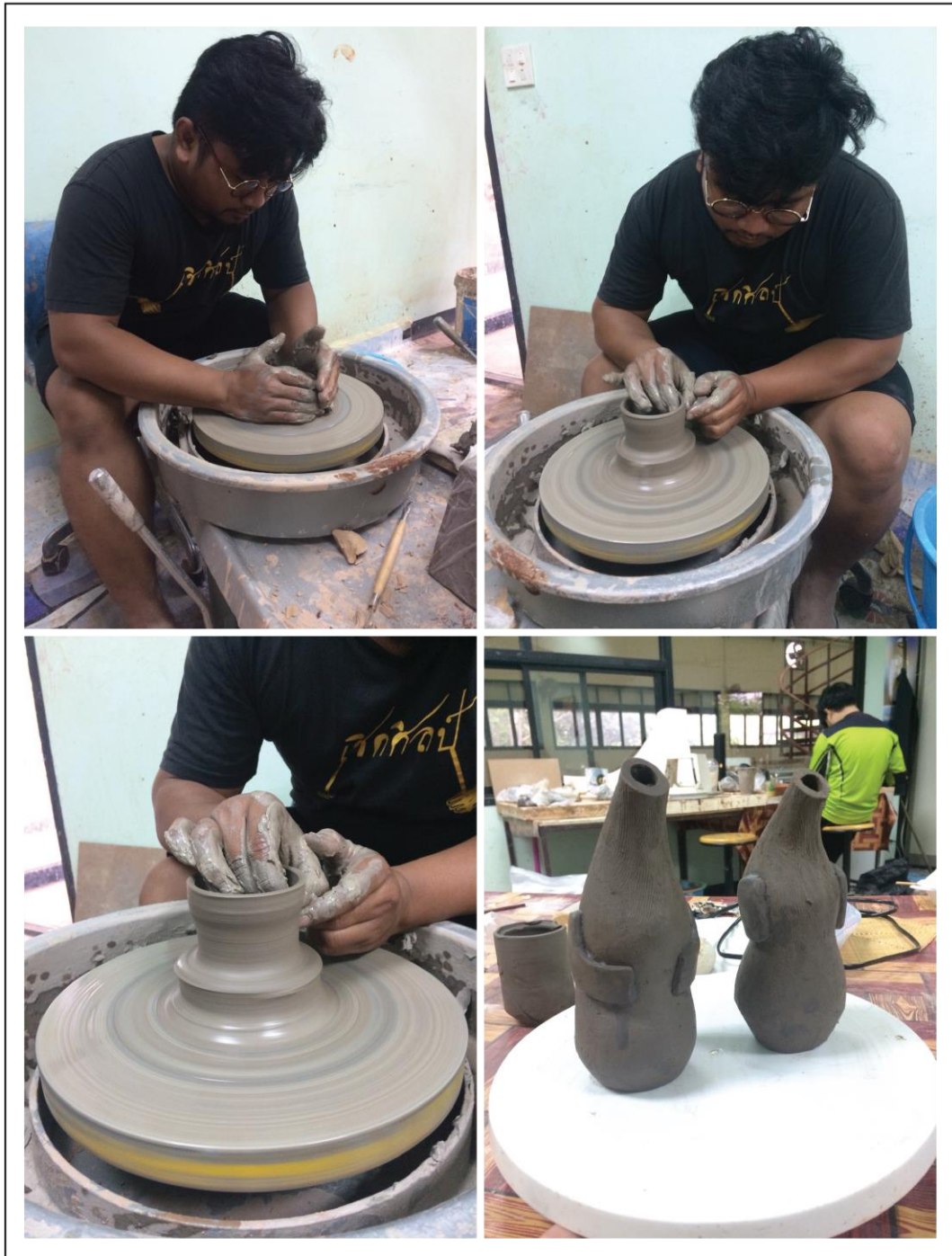
ภาพที่ 93 ขั้นตอนขึ้นรูปด้วยแป้นหมุนไฟฟ้าและปรับฟอร์มตามแบบร่าง
