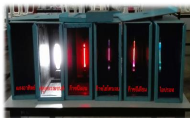
รูปที่ 3 การตรวจสอบความพร้อมใช้งานของแหล่งแสงต่างๆ เพื่อศึกษาสเปกตรัมของธาตุ
