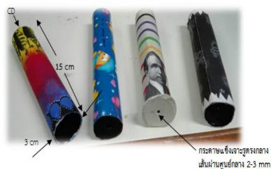
รูปที่ 2 กล้องสเปกโตรสโคปอย่างง่ายจากแผ่น CD
