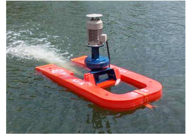
เครื่องกลเติมอากาศแบบอัดอากาศและดูดน้ำ
