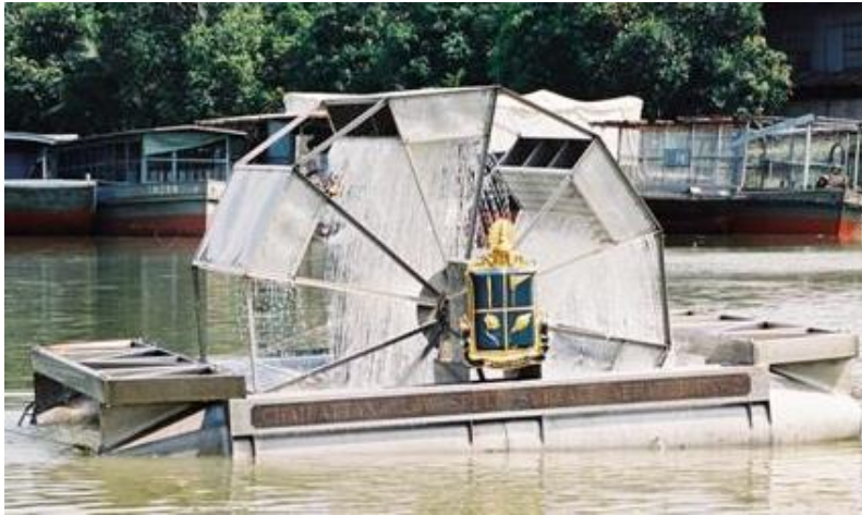
เครื่องกลเติมอากาศที่ผิวน้ำหมุนช้าแบบทุ่นลอย (กักหน้ำน้ำชัยพัฒนา)
