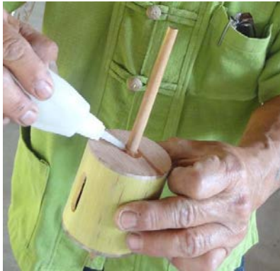
รูปที่ 7 ทากาวเพื่อยึดเดือยให้ติดแน่นกับตัวบะข่างไว่
