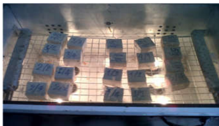
Figure 3 การอบชิ้นงานตัวอย่างทดสอบด้วยตู้อบไฟฟ้าที่อุณหภูมิ 100 องศาเซลเซียส
