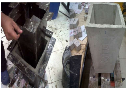
Figure 8 การหล่อชิ้นงานกระถางต้นไม้
