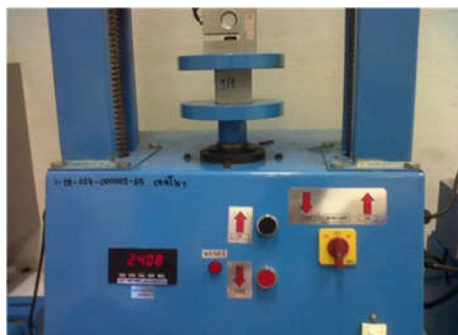
Figure 4 การทดสอบการทนต่อแรงบีบอัดด้วยเครื่องทดสอบแรงบีบอัด
