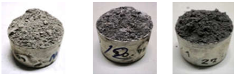
ปูนซีเมนต์ปอร์ตแลนด์ เถ้าปาล์มน้ำมัน เถ้าปาล์มน้ำมัน ประเภทที่ 1 ก่อนบด บดแล้ว
