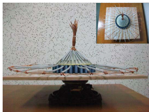
รูปที่ 3 การจัดเรียงอิเล็กทรอนิกส์คาปาซิเตอร์แบบขนานรอบๆ กรวย
