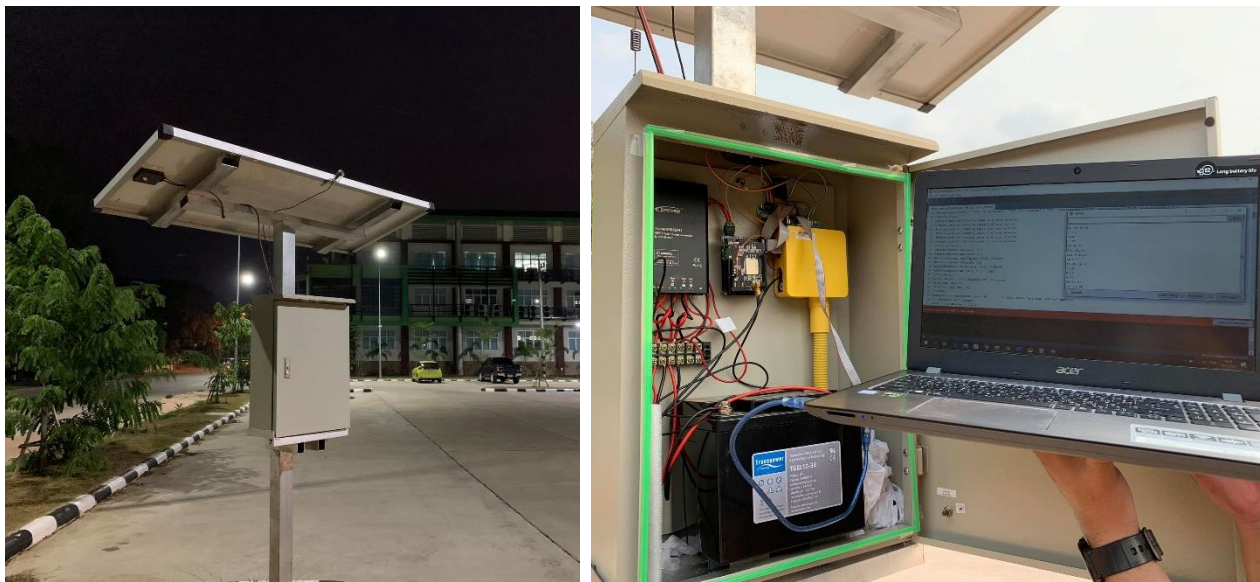
ภาพที่ 2 โครงสร้างทางกายภาพของสถานีวัดคุณภาพอากาศที่พัฒนาขึ้น
