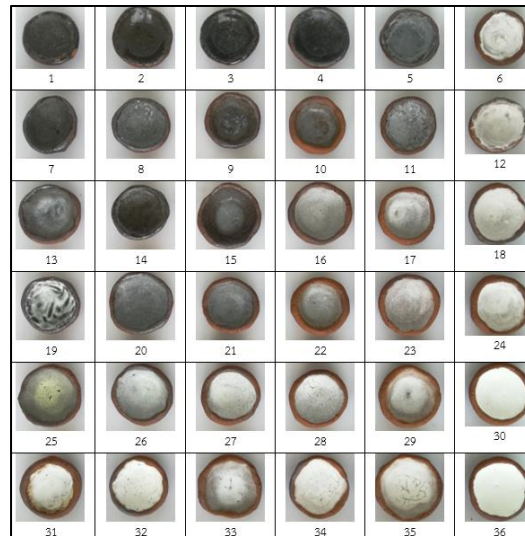
ภาพที่ 3 ผลการทดลองเคลือบสูตรที่ 1
