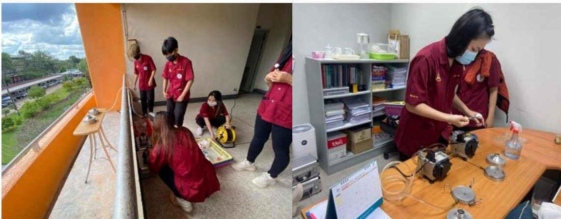
ภาพที่ 42 ตัวอย่างการตรวจวัดคุณภาพอากาศและละอองลอยชีวภาพบริเวณอาคารวิจัย ชั้น 3 และห้อง SC309
