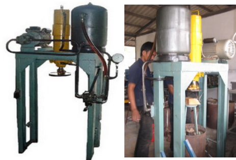
ภาพที่ 4 เครื่องอัดไฮดรอลิคที่ใช้บรรจุเตาชีวมวล
