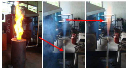
(a) แสดงเปลวไฟจากเตาชีวมวล (b) แสดงก๊าซที่เกิดขึ้นจากเตาชีวมวล (c) แสดงเปลวไฟจากการจุดก๊าซ
