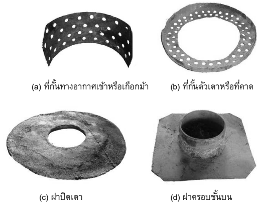
ภาพที่ 3 อุปกรณ์ประกอบโครงสร้างภายในของเตาชีวมวลทรงกระบอก
