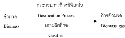
ภาพที่ 1 การเปลี่ยนเชื้อเพลิงแข็งให้เป็นก๊าซเชื้อเพลิง
